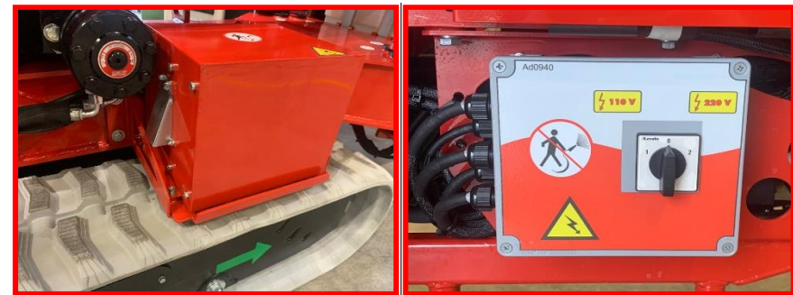
Figure 7a: alternateur et sélecteur (* en option).
